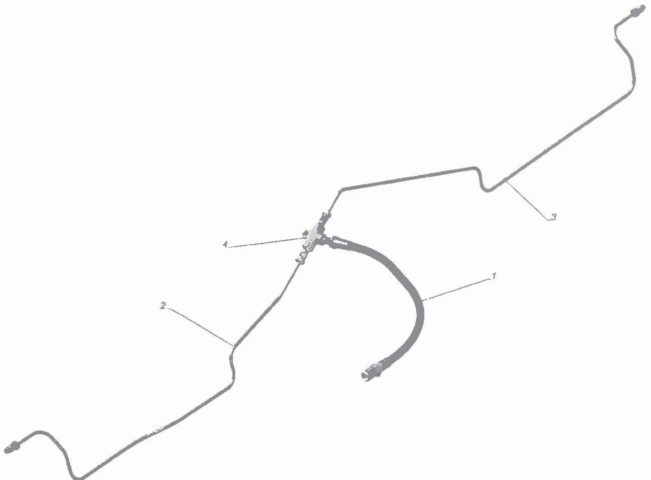
ГАЗель плюс Рис. 3302-3506009-20. Трубопроводы заднего моста с тройником и шлангом
