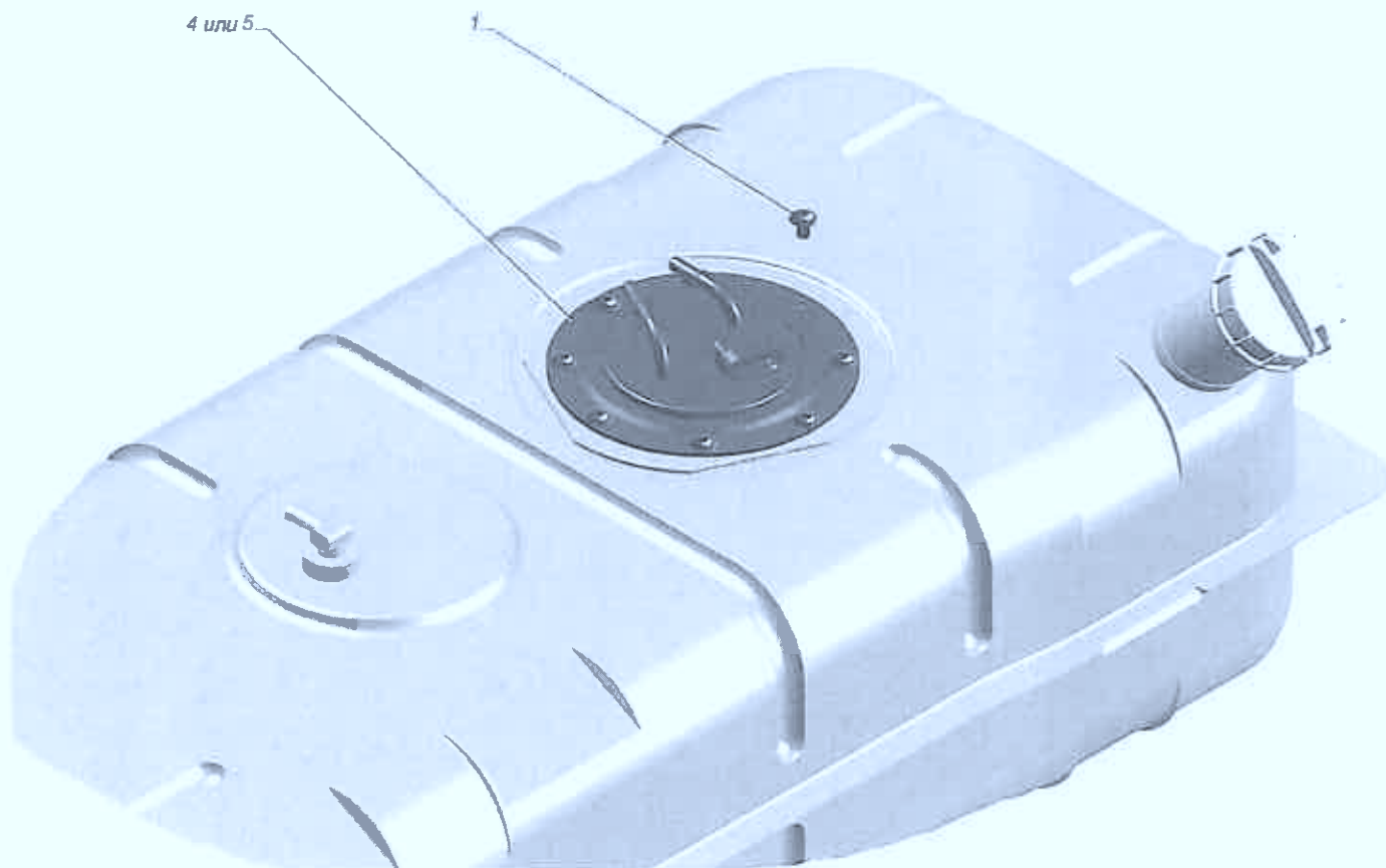
ГАЗель плюс Рис. 2217-1139001. Установка модуля погружного электробензонасоса
