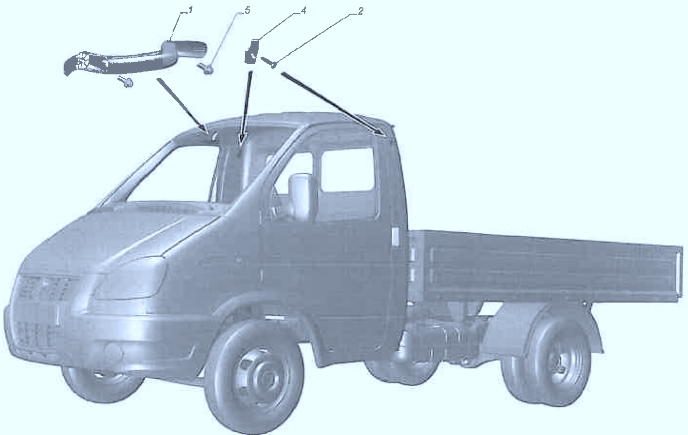
ГАЗель плюс Рис. 3302-8202002. Установка поручня и крючков для одежды
