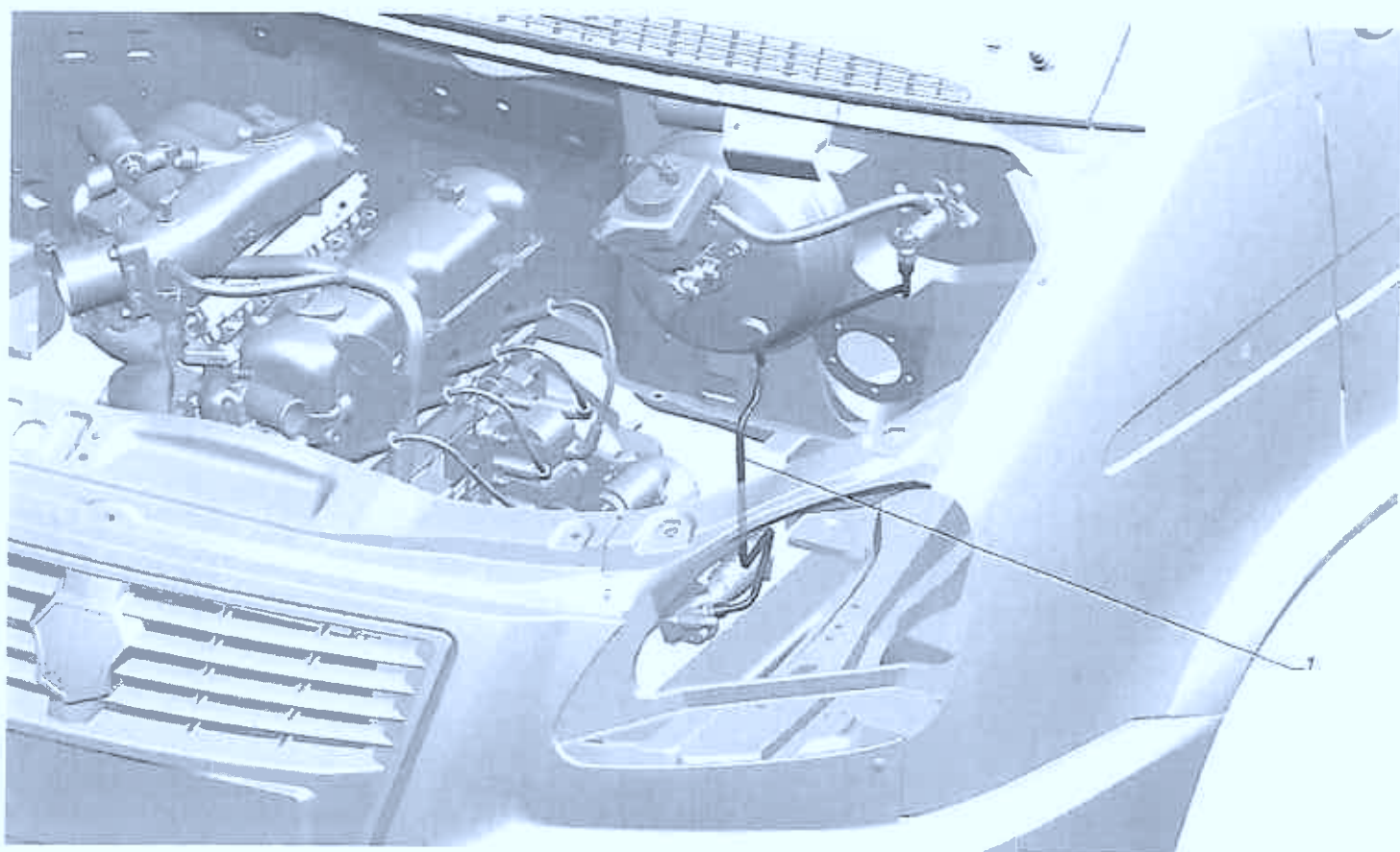
ГАЗель плюс Рис. 3302-1602001-20. Установка привода управления сцеплением и тормозом
